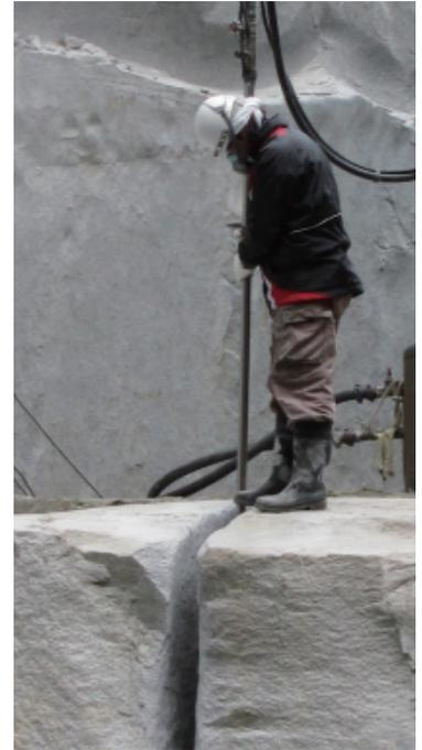
明治初期の切り出し現場は危険を伴う大変な重労働でしたが、昭和 30 年頃の需要拡大にあわせて、搬出用の機械や採掘用の削岩機、ジェットバーナーなどの登場でその生産スタイルは大きく変化しました。現在でもジェットバーナーを中心にした切削機で、大島石に最もふさわしいやり方での切り出しをおこなっています。
